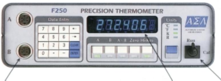
Moderní design a použití tlačítek s doprovodným slyšitelným kliknutím, zpříjemňuje používání F250 a snižuje chyby zaviněné obsluhou.
