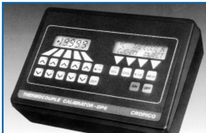
Tento přenosný termočlánekový kalibrátor je kompaktní, snadno použitelný přístroj, vhodný pro kalibrační laboratoře i pro servisní účely. DP6 může být použit pro měření i pro simulaci výstupů 10 nejoblíbenějších typů termočláneků se stupnicemi v °C, °F, K nebo mV. Automatická kompenzace srovnávacího spoje je opatřena možností ručního zadání hodnoty. Úplnou mobilitu zajišťuje napájení z akumulátoru, který umožňuje více než 15 hodin trvalého provozu.
