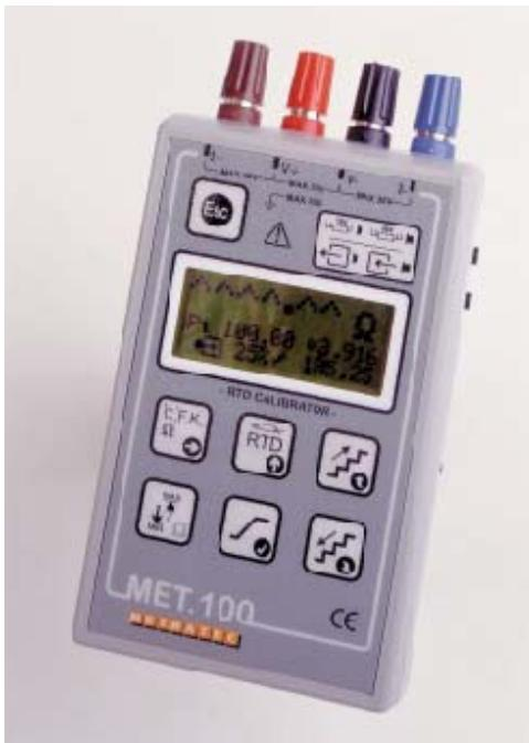
MET je konstruován pro situace, kdy je nezbytná přesná kalibrace a řízení měřicích přístrojů pro měření teplot s odporovými teploměry (OT). Se svou vysokou přesností a 8 standardními typy OT, volitelnou možností použití nestandardních křivek a schopností kompenzace odchylek sond je ideální jako příruční kalibrátor. Při použití vhodné kalibrované sondy se změní v teploměr se známou vysokou přesností.
