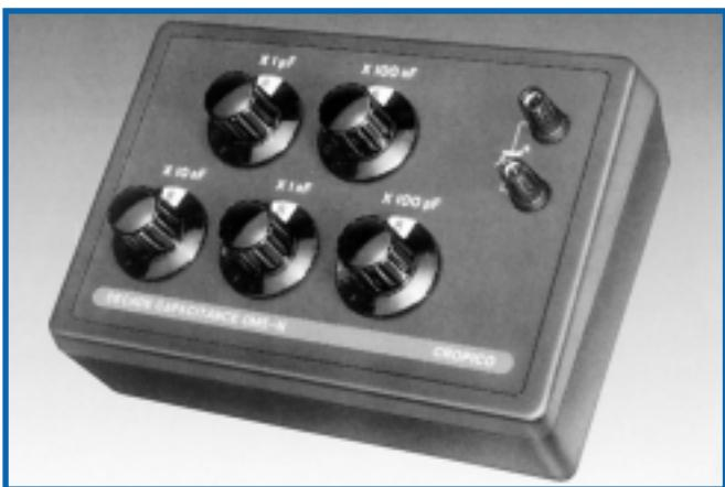
Pětimístná kapacitní dekáda doplňuje odporové dekády řady RM6N. CM5N je zhotovena ve stejném ergonomickém stylu a je užitečným doplňkem kterékoli laboratoře. Použité kondenzátory jsou kombinací polykarbonátových a polystyrenových, s dobrým ztrátovým úhlem a velkým izolačním odporem. Vlastností této jednotky je, že zbytková kapacita je kompenzována na dekádách se stupnicí  $10 \times 100\text{pF}$  a  $10 \times 1\text{nF}$ . Hodnota nastavená přepínačem na stupnici se objeví též na svorkách.
