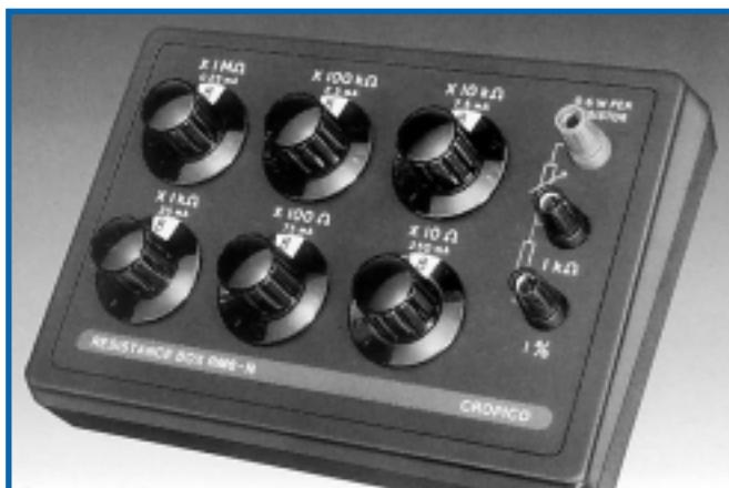
RM6N je k dispozici ve třech modelech, každý se 6 dekádami, ale s nejnižšími dekádami začínajícími na 1, 10, respektive 100 ohmech. Jsou atraktivně uspořádány v prostorově úsporném krytu, u výstupních svorek jsou přídavné rezistory 1 kilohm, takže umožňují uživateli vytvořit jednoduchý dělič. Série RM6N je osazena 0,6 W rezistorů s kovovou vrstvou s tolerancí 1%. Tvoří ideální nástroj pro použití ve školství a ve všech elektrotechnických dílnách.
