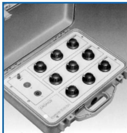
Tato vysokoohmová odporová dekáda, využívající ve své konstrukci kvalitní přepínače Cropico a speciálně vybírané rezistory, je ideální pro kalibraci souprav pro zkoušení izolace, s napětím v rozsahu až do 5 kV. Je vestavěná do robustního přenosného kufříku a se svými 9 dekádami pokrývá rozsah od  $1\text{k}\Omega$  do  $600\text{G}\Omega$ .
