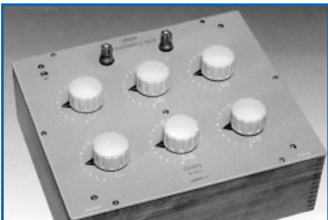
Odporové dekády řady RB jsou k dispozici ve verzích s 5 nebo 6 dekádami a s přesností 0,005% na první dekádě. Vysoká přesnost a stabilita je dosažena použitím vlastních, námi vyvinutých přepínačů, kombinovaných s bezindukčními odpory, vinutými, stárnutými a dostavovanými pod nejpřesnější kontrolou jakosti. Pro simulaci Pt100 jsou k dispozici speciální modely pro nejvyšší přesnost. Dekády Wagner Wolf jsou použity pro minimalizování vlivu přechodového odporu spínačů.
