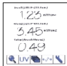
Hodnoty absolutního radiometru zobrazené velkými číslicemi v uživatelsky definovaných pásmech vlnových délek
